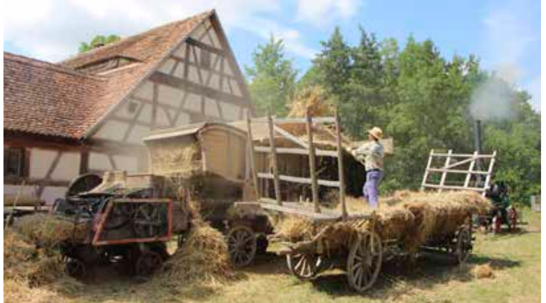
Aus den 1930er Jahren stammend, wird diese Dreschmaschine mit einer Dampf-Lokomobile betrieben.
